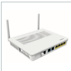
(Optical Network Terminal) ONT -کاربری در شبکه های FTTH -نصب در داخل ساختمان مشترکین -امکان سرویس دهی ( تلفن و اینترنت پر سرعت IPTV) به مشترکین -امکان اتصال کاربران به صورت باسیم و بی سیم
