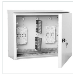
جعبه دسترسی فیبرنوری فلزی ( FAT ) تجهیزاتی که جهت قرار گیری اسپلیترها و کابل های توزیع خارجی (مخابراتی) و داخلی و با توجه به تعداد کابل های خروجی میتوان از سایزهای 12، 24، 48 و ... استفاده نمود. کاربرد: ترمینال دسترسی فیبر برای اتصال و ارتباط داخلی کابل های فیبر نوری در تکنولوژی FTTH مورد استفاده قرار می گیرد. ظرفیت: ۲۴ و ۴۸ ظرفیتی
